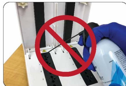
NON cercare di pulire lo strumento Alethia utilizzando aria compressa
