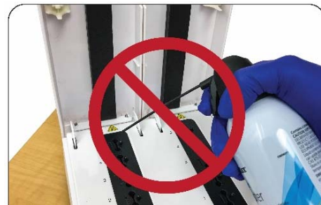
Versuchen Sie NICHT, das Alethia-Instrument mit Druckluft zu reinigen.
