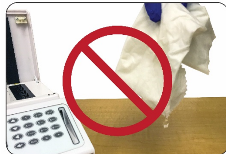
NE PAS UTILISER de chiffons ou d'écouvillons en mousse sursaturés de solution de nettoyage
