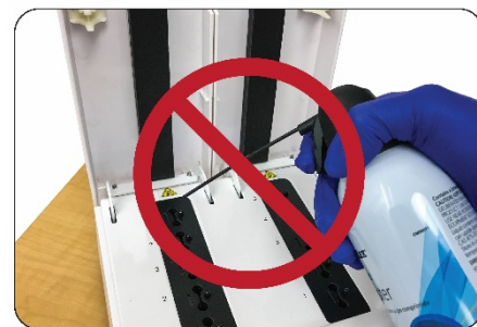
NE PAS nettoyer l'instrument Alethia avec de l'air comprimé
