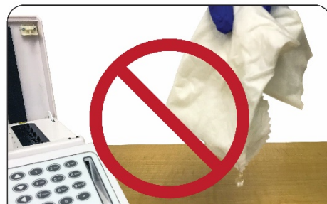
Verwenden Sie KEINE übersättigten Tücher oder übersättigten Schwammstäbchen zur Reinigung.
