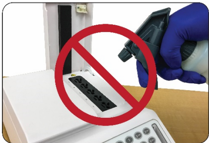
NE PAS vaporiser une solution sur l'instrument Alethia
