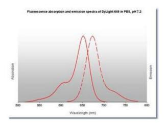
**Diagram**DyLight™ 649 Fluorescence Spectra.
